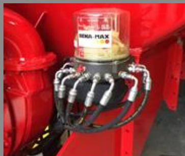
SYSTÈME DE GRAISSAGE AUTOMOBILE
