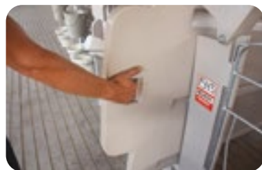
Panneau séparateur qui permet de configurer l'enclos.
