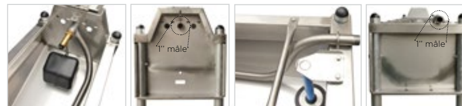
Exemple de montage avec coudes en inox et raccord PE
